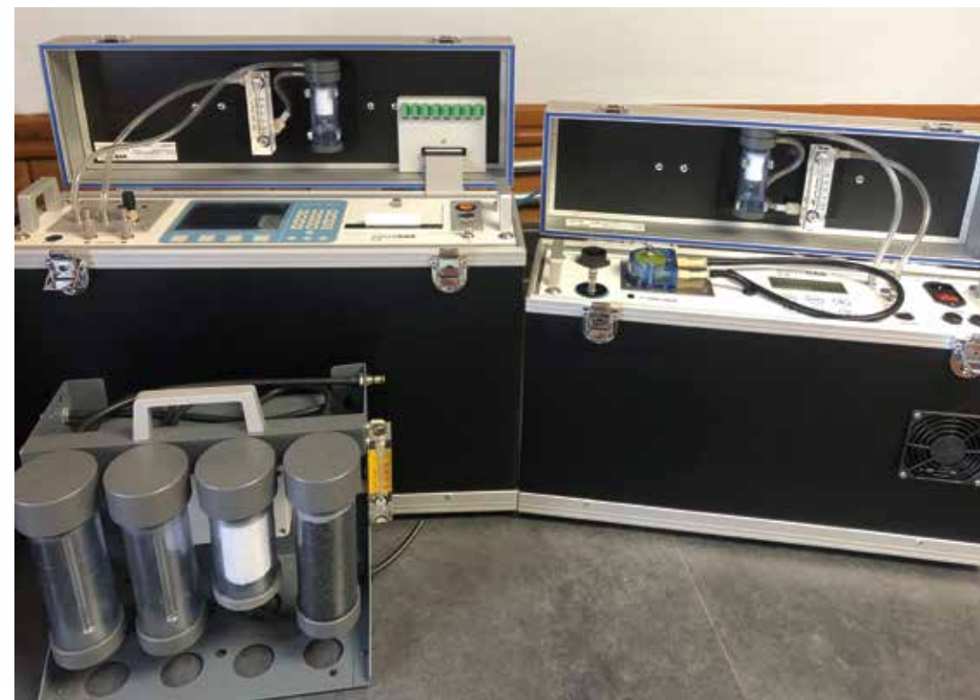
ANALYSEUR EN CONTINU DE SYNGAZ/POUVOIR CALORIFIQUE
