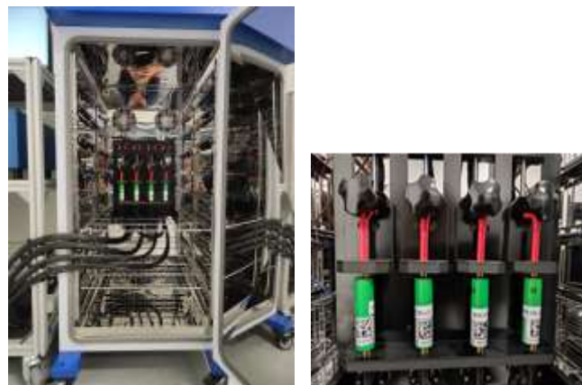
Figure 3. Les tests sur les 4 cellules de Sony VTC6
