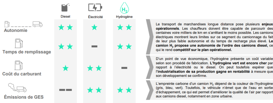
Figure 30. Comparatif des différents modes de propulsion des camions [62].
