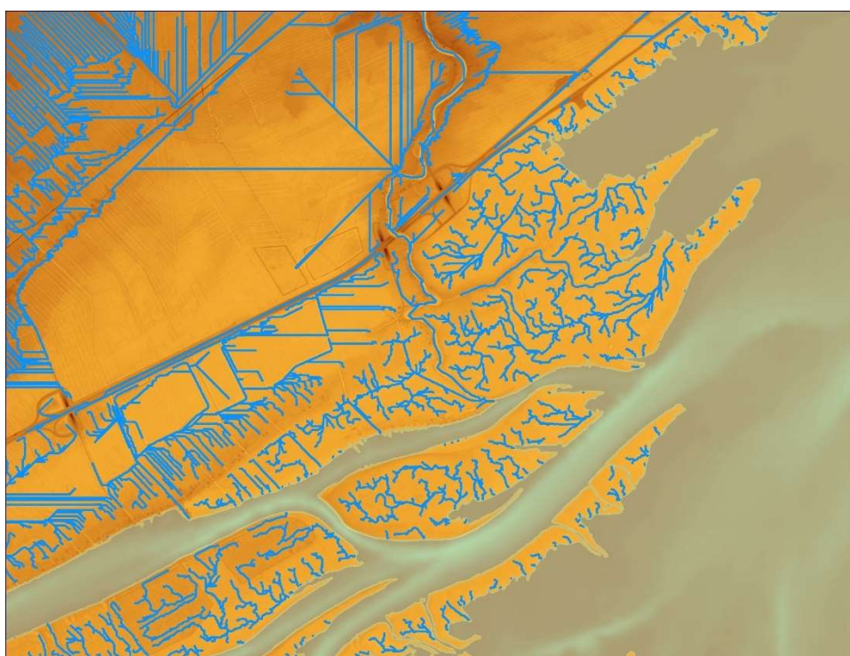
Figure 4A.4. Modélisation du réseau hydrologique à partir d'un MNT sans le traçage des ponceaux. Le drainage n'obéit pas aux dépressions des terrains agricoles puisque les ponceaux sont inexistants dans le modèle.
