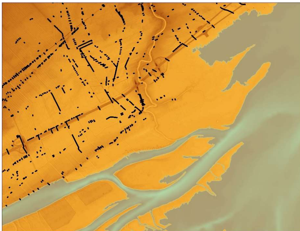
Figure 4A.3. Une région autour du lac Saint-Pierre où les ponceaux ont été tracés afin de relier les talwegs de part et d'autre d'une route ou d'un chemin agricole.
