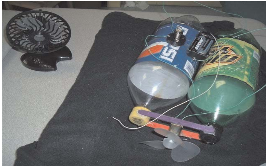
Figure 2 : À gauche, un ventilateur avant le démontage ; à droite, le ventilateur transformé en aéroglisseur
