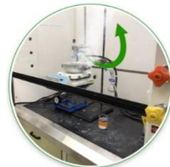
**Fig. 29** Démonstration de l'aspiration dans la hotte lorsque le châssis est à la bonne hauteur
