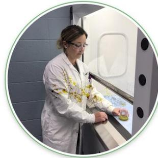
**Fig. 27** Démonstration de la protection offerte lorsque le châssis est à la bonne hauteur
