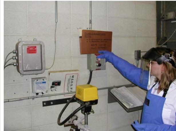
7. Ouvrir lentement la **valve manuelle** afin de refroidir le contenant et lorsque la vaporisation diminue, ouvrir plus grand
