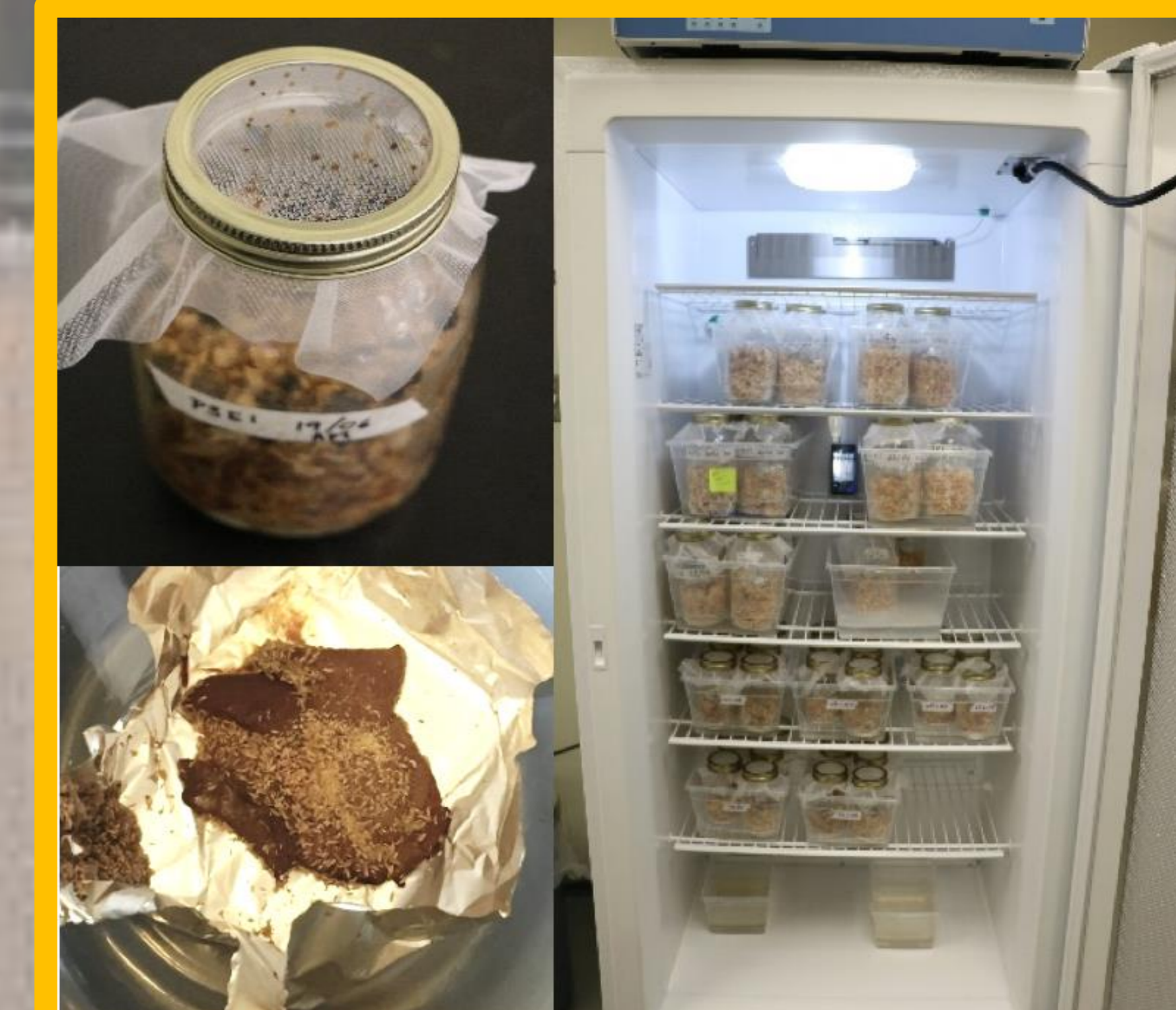
Figure 3: Chambre de croissance et montage effectué en laboratoire pour l'élevage des œufs et des larves de diptères jusqu'au stade adulte
