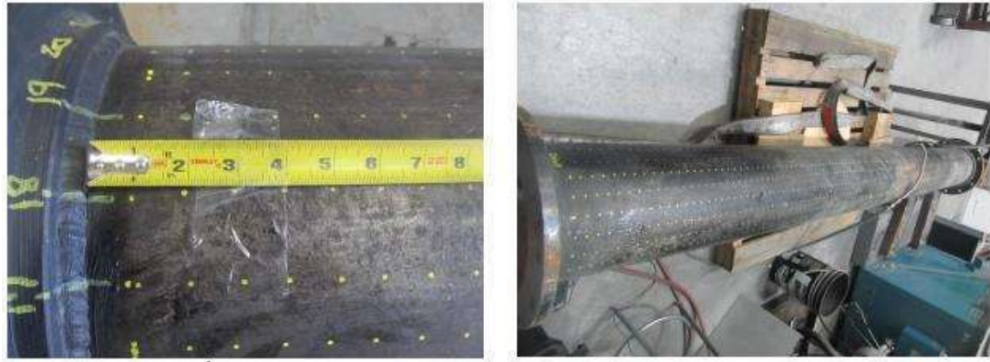
Figure 5: Étape de marquage (gauche) et vue d'ensemble (droite) du tuyau témoin
