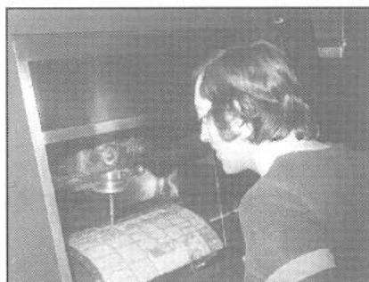
1975, Gaston Guilbert abaisse le plomb, pour une couleur d'accompagnement, au moyen d'une guillocheuse.
